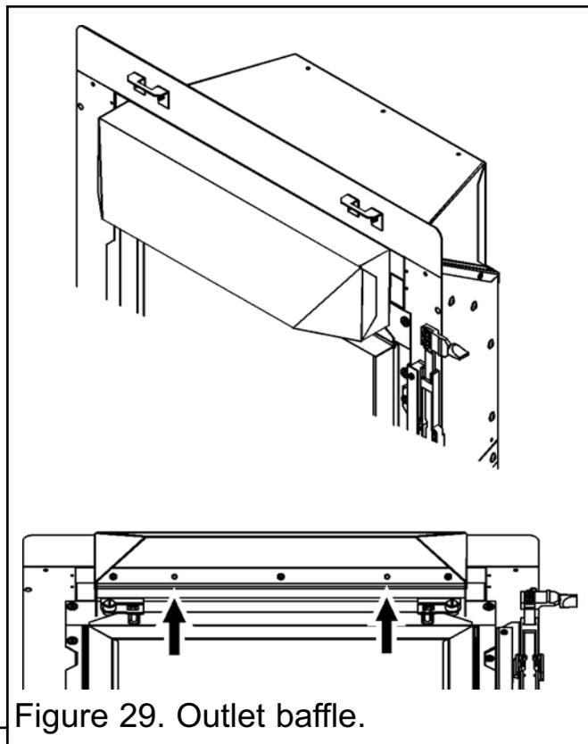
Figure 29. Outlet baffle.
